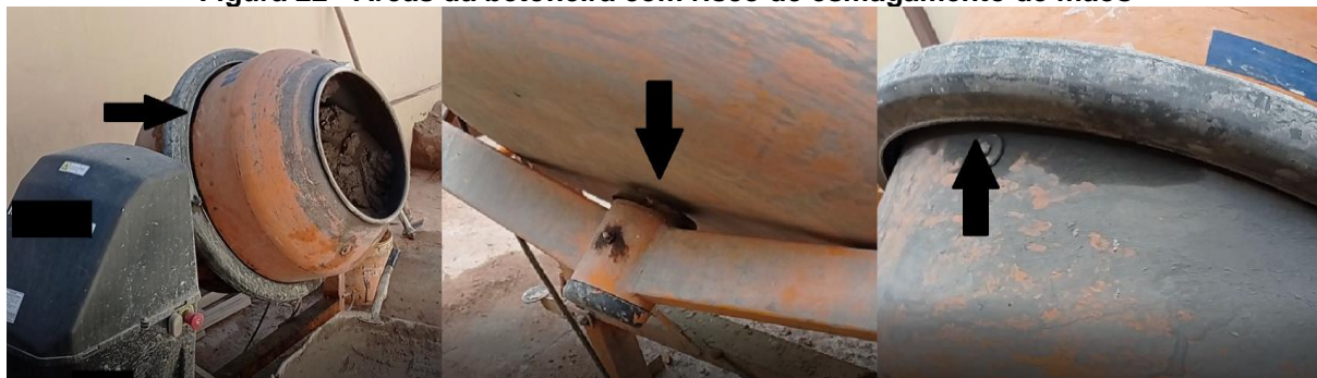
Figura 22 - Áreas da betoneira com risco de esmagamento de mãos
