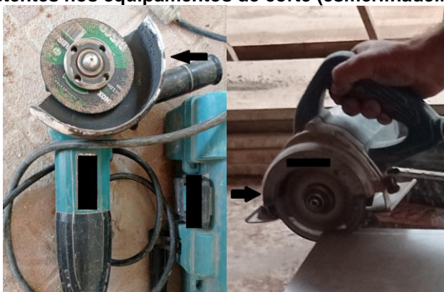
Figura 21 - Proteções existentes nos equipamentos de corte (esmerilhadeira e serra mármore)
